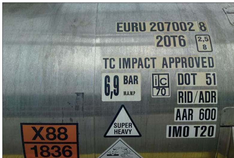
Ein alter IMO T20 Tank, der nach Übergangsbestimmung weiterverwendet werden darf.
